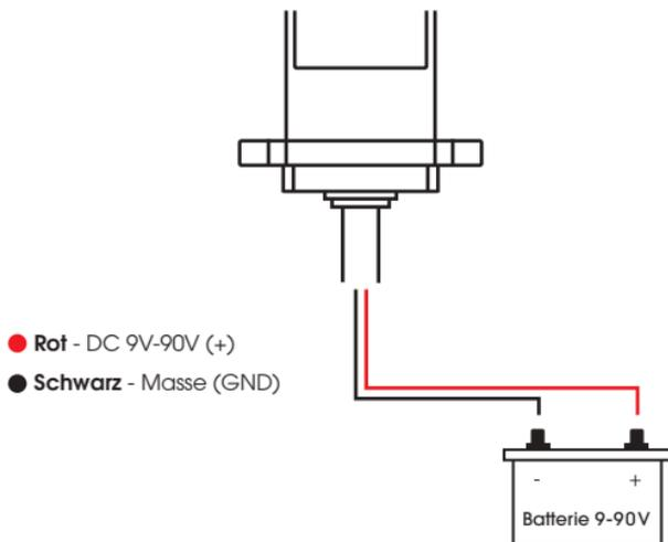
**Dieser Tracker ist für die Verwendung in einem Fahrzeug vorgesehen. Das Testen des Trackers mit einer separaten Batterie oder Haushaltsbatterie wird daher nicht empfohlen. Platzieren Sie den Tracker direkt an die Bordspannung oder die Starterbatterie des Fahrzeugs an, für das er bestimmt ist.**
